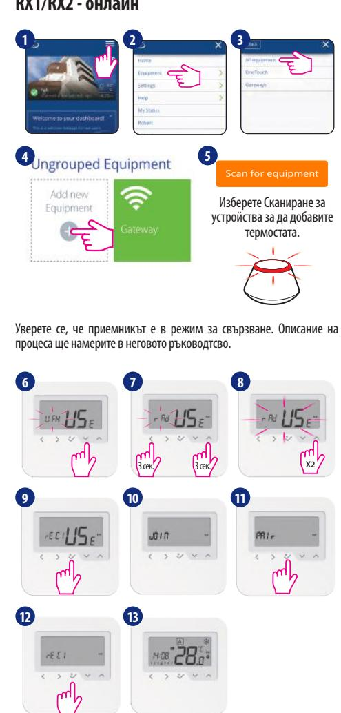
За свързване с конфигурация RX2, превключете приемника в позиция RX2 и изберете  $rE L2$  в стъпка 4. След това продължете с настройката както е описано.
